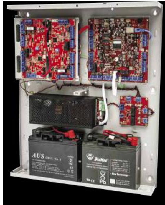
IAC parodytas 8 durų / 10 skaitytuvų konfigūracijoje. (IAC su prijungtais UniBus 2 Door / 2 Reader išplėtimu įrenginiais). Įrengtas WideBody korpuse su vyrių plokšte, 8 Amp maitinimo šaltiniu, Fire Door rėlės kortele ir 2 x 17 Ah akumuliatoriais.
